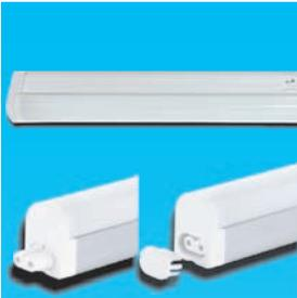
**Wand- und Deckenleuchte inkl. Verbindungskabel, Anschlußkabel und Adapter. Gehäuse: Alu;** Gehäusefarbe: Alu. Glas / Schirmmaterial Kunststoff weiß. Mit Wippschalter. **Inkl. LED - nicht austauschbar.** Mittlere Lebensdauer ca. 25.000 h. Energieeffizienz: A+. Schutzart IP20. Schutzklasse 2. 220-240V~50Hz.
